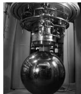
Afb. 6. Foto van de bol hangend aan de trillingsdempers, met daarboven de mengkoelmachine.
